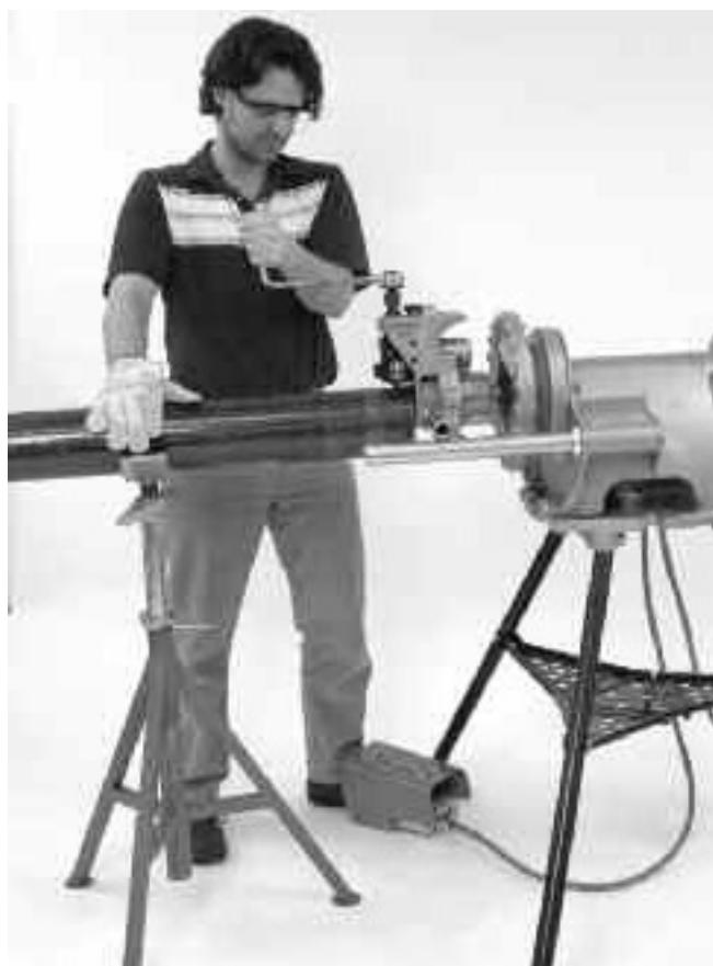
**Рисунок 13 – Нажим на трубу с целью улучшения прокатки**
