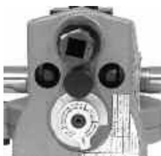
Рисунок 15A – Выбор положения регулятора глубины желобка под головкой регулировочного винта
