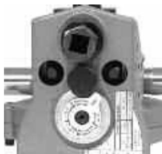
**Рисунок 12 – Регулятор в положении прокатки**
