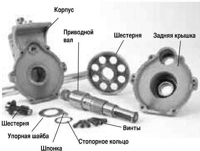
Рисунок 20 – Обозначение компонентов устройства для накатки желобков 975 Combo
