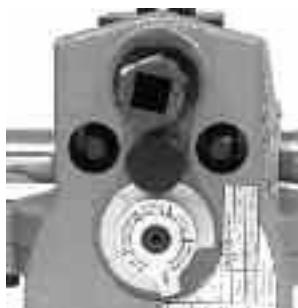
**Рисунок 10А – Выбор положения регулятора глубины желобка под головкой регулировочного винта**
