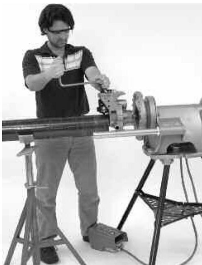
**Рисунок 12 – Рабочая позиция устройства для прокатки желобков**
