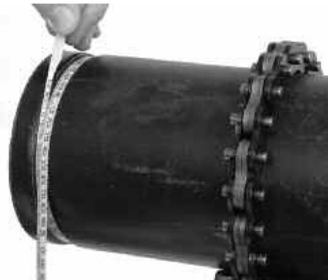
Рисунок 16 – Проверка диаметра желобка с помощью измерительной ленты
