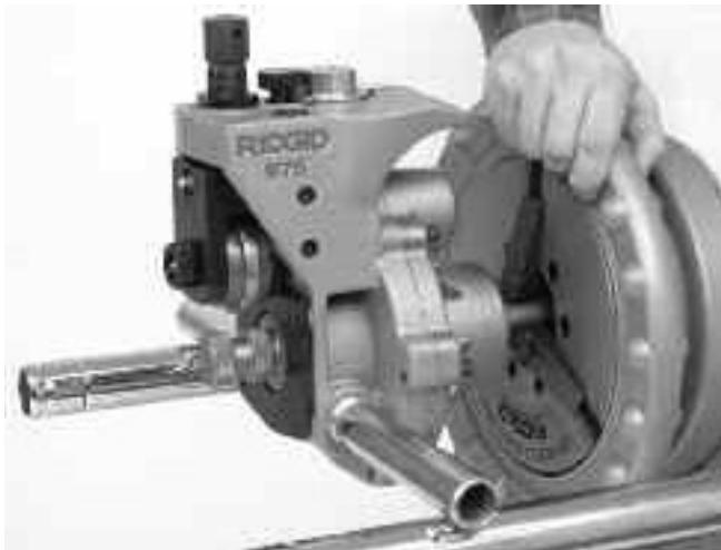
Рисунок 3 – Установка устройства для накатки желобков 975 Combo в зажиме силового привода 300
