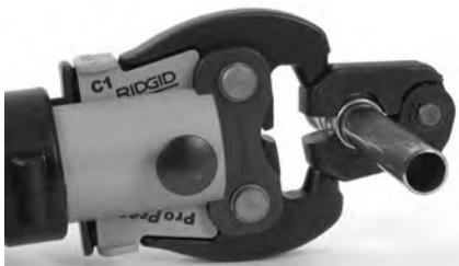
Рис. 10 – Крепление рабочей насадки на обжимном кольце
