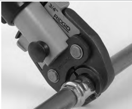
Рис. 7 – Установка пресс-клещей ножничного типа вокруг фитинга
