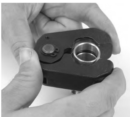
Рис. 9 – Установка обжимного кольца на фитинг
