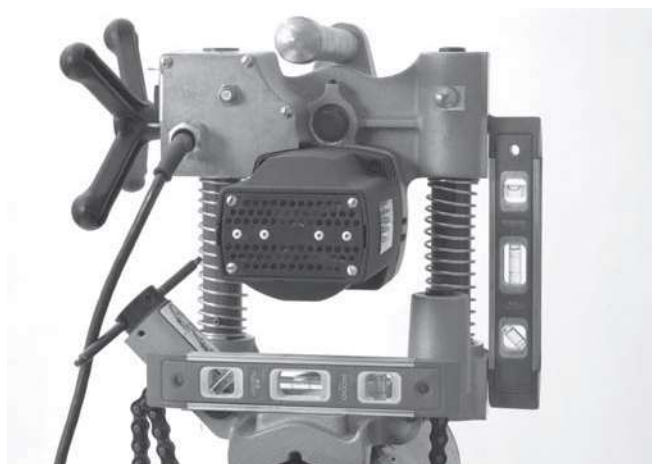
Рис. 10 – Выравнивание станка HC-300
