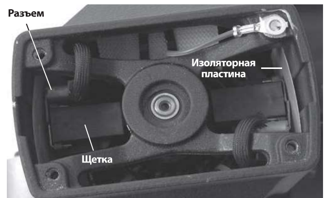
Рис. 12 – Установка щетки на двигателе со снятой крышкой
