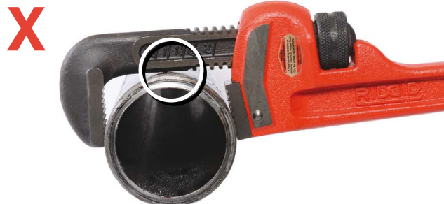
Рис. 4 – Ключ слишком мал для работы с изделием, хвостовик верхнего захвата касается изделия.
