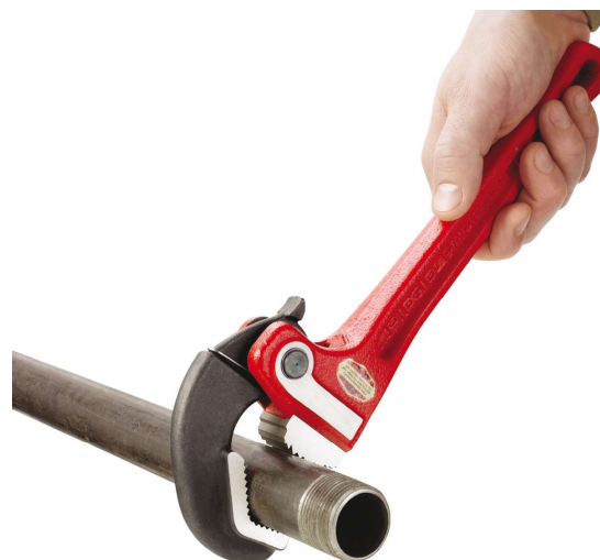
Рис. 5 – Использование ключа RapidGrip
