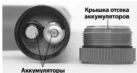
Рис. 7 – Замена аккумуляторов (приемник)
