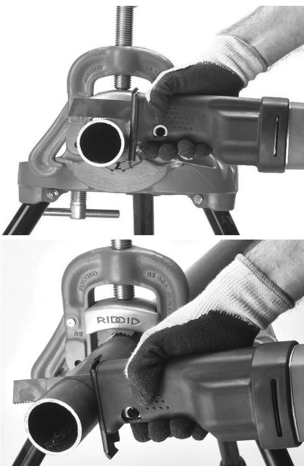
Рис. 16 - Ручная резка без направляющих устройств
