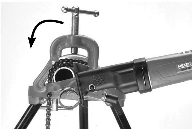
Рис. 15С- Резка трубы
